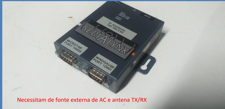
Necessitam de fonte externa de AC e antena TX/RX
